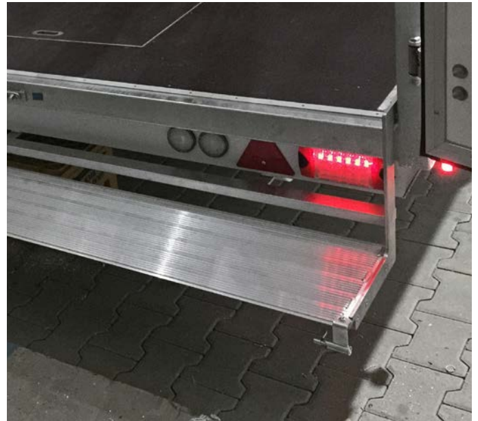
Klapp- oder ausziehbare Treppe für Hecktür-Variante
