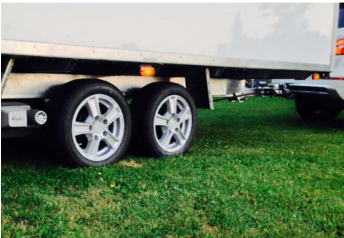
Bodenfreiheit mit längen- und höhenverstellbarer Deichsel
