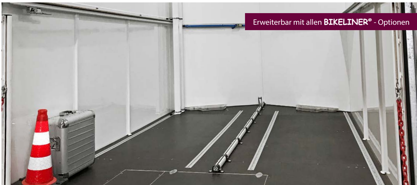
BIKELINER® Luggage Line für bis zu 2,5t Gepäck, inkl. BAG-konforme Ladungssicherung und Diebstahlschutz
