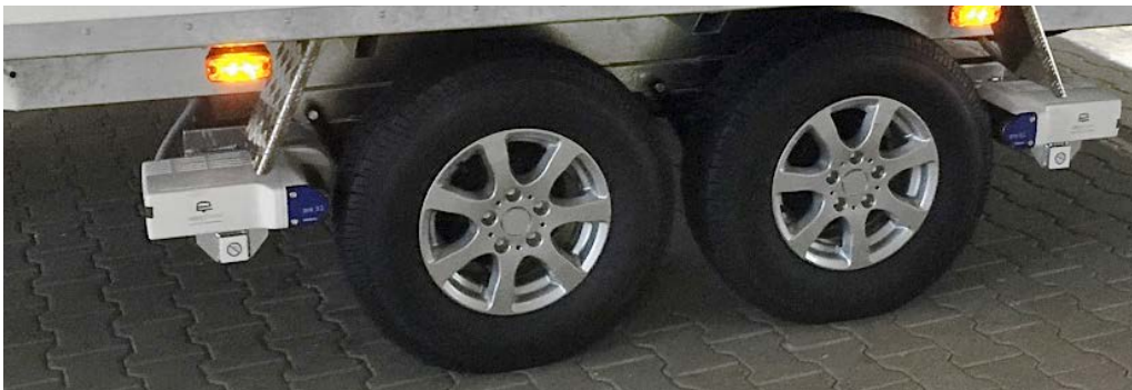
Mover: Der Reich easydriver mit 14" Bereifung mit optionaler Steuerung per App
