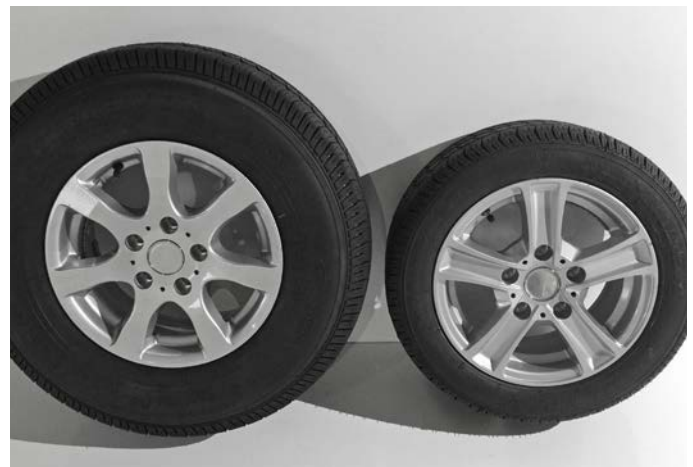
Empfohlene 14" Bereifung / 13" Reifen der Basisversion
